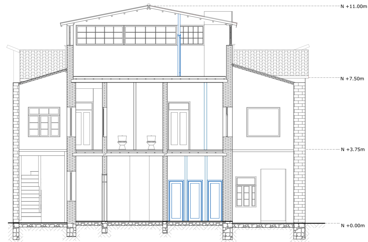
Sección Transversal ● Intervención
