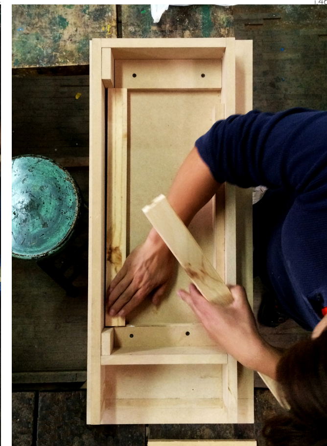
2. Paso 2 _ Colocación de primer y segundo parante en matriz.
