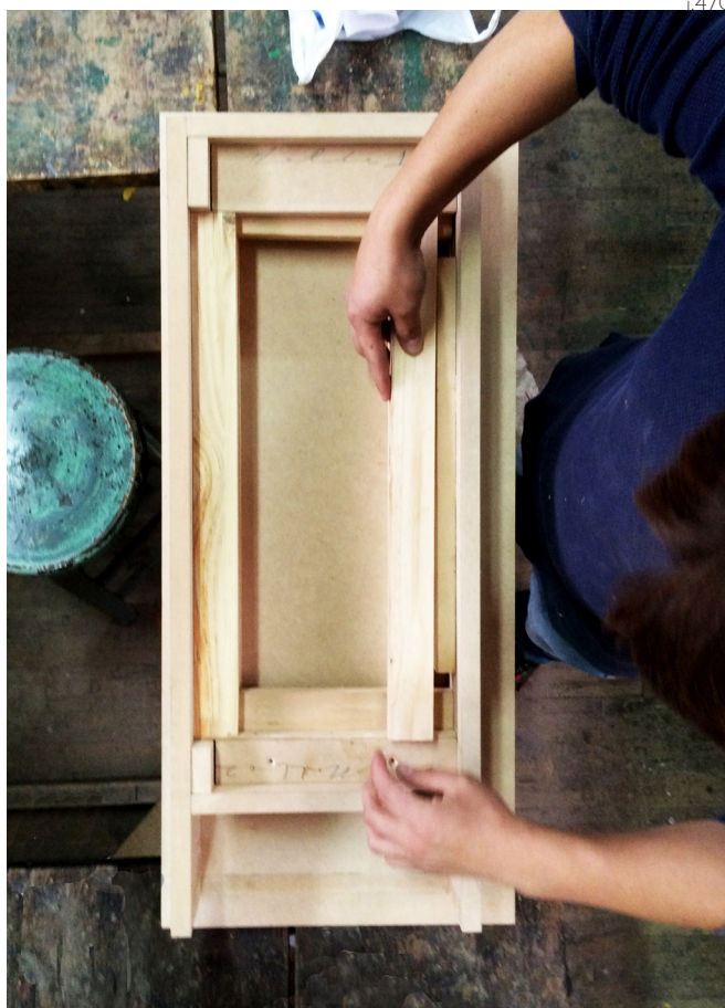
7. Paso 4 _ Colocación de tercer y cuarto parante
