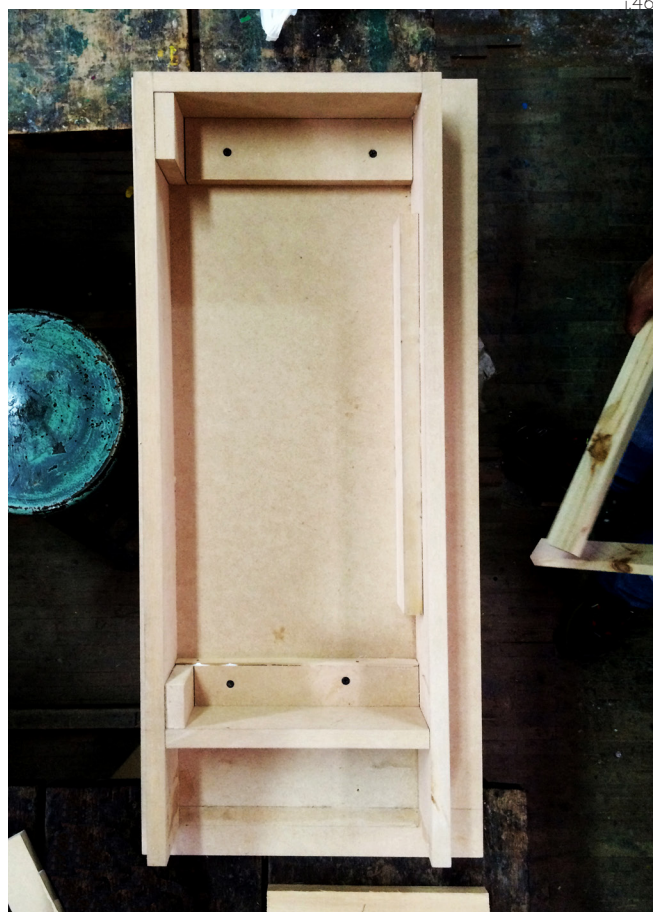
1. Matriz para armado de paneles.
