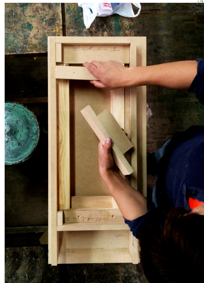
5. Paso 5: Colocación de fijadores para parantes.
