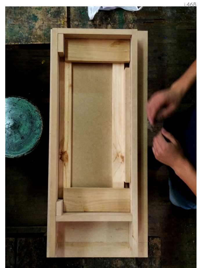
5. Paso 2 _ Colocación de soleras en matriz.
