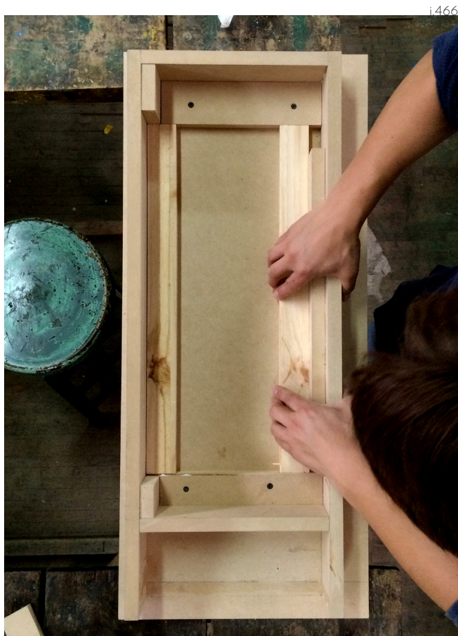
3. Paso 2 _ Colocación de primer y segundo parante en matriz.
