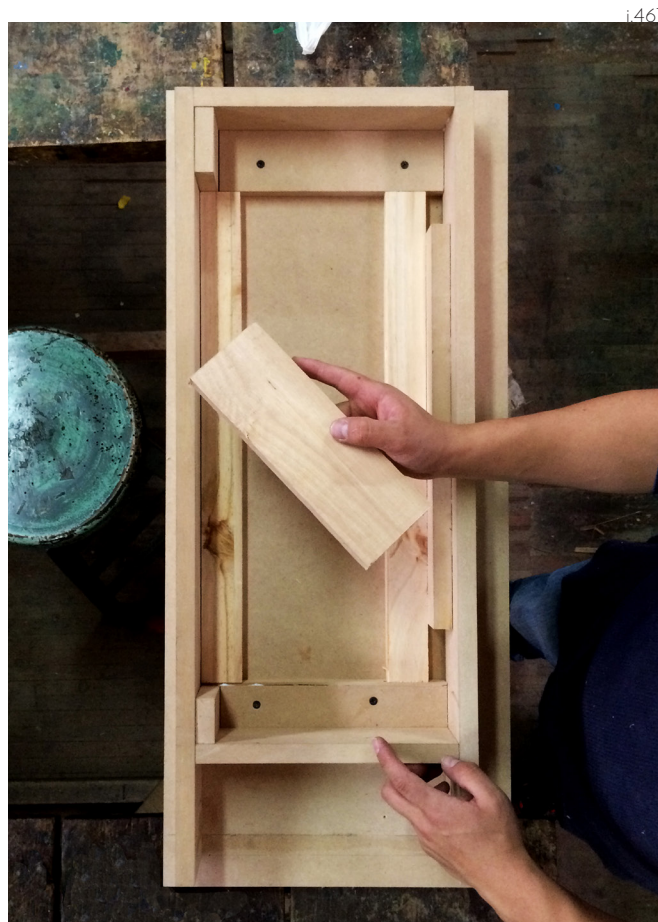
4. Paso 2 _ Colocación de soleras en matriz.
