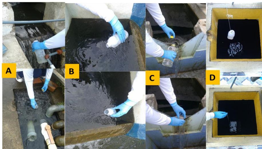
Figura 17. Toma de muestra para análisis fisico-químico y microbiológico. A: agua de entrada 1 y agua de entrada 2, B: salida de filtros rápidos, C: salida de filtro lento, D: agua tratada.
