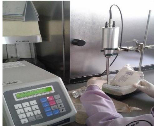
Figura 2.9: Ultrasonificador LD (Tiempo 15min. Temperatura: 10^{\circ}\text{C} ).
