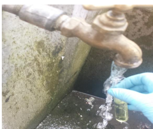
Imagen 14: Prueba de ortotolidina en inmuebles
