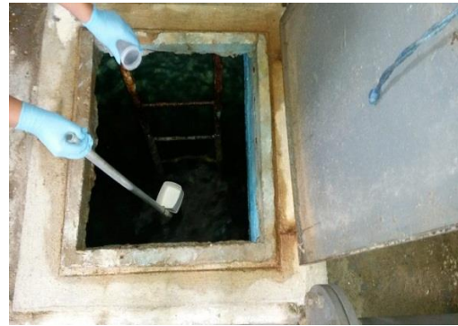
Imagen 10: Toma de muestra de Agua tratada
