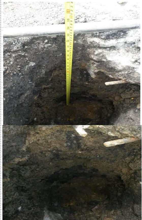
Figura 3. 4 Perforaciones a cielo abierto - calicatas en el proyecto Zhud – Biblián (MTOPI Informe de hallazgos mediante radar de penetración terrestre)
