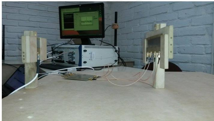
(b) Maqueta para medición del patrón de radiación con NI-PXIe-1075
