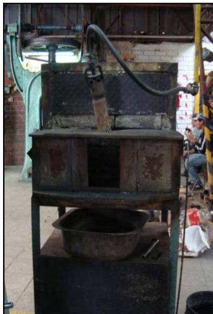
FIG. 7 HORNO PRECALENTADOR DE TORCHOS
