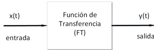
Figura 2.6: Función de transferencia
