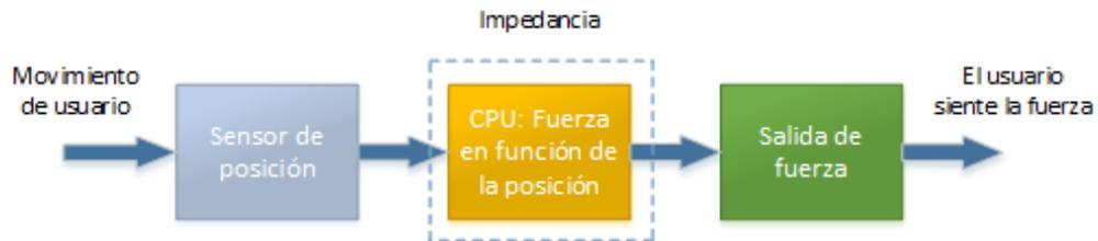
Figura 2.2: Dispositivo tipo Impedancia
