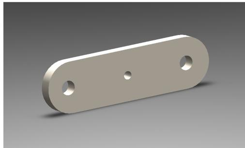
Figura 3.9: Soporte para sujetar la pala háptica
