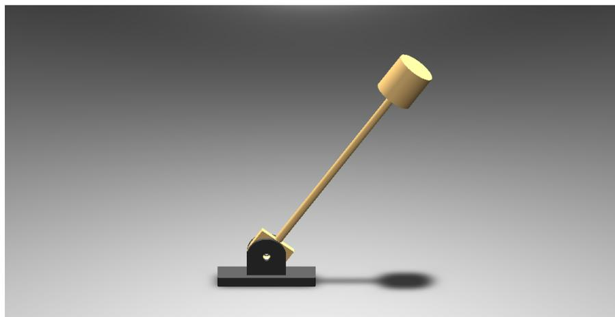
Figura 5.3: Ensamble final del péndulo invertido virtual - Solidworks
