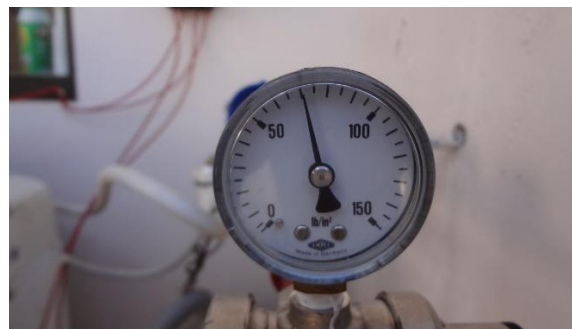
Figura 4.7 Presión de agua a la red
