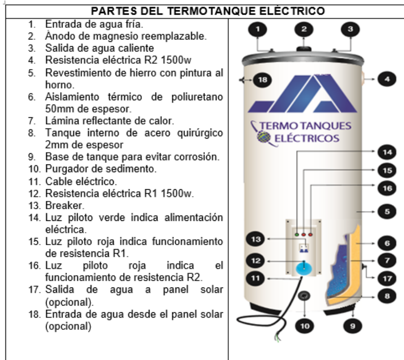
Figura 2.7 Partes del termotanque
