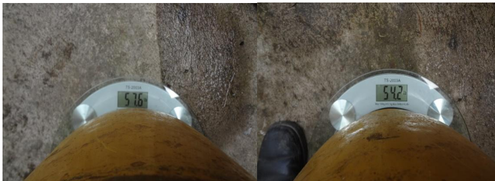
Figura 3.17 Fotografía del registro de consumo de GLP
