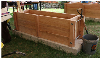
Fotografía 18: Tapialera. Fuente: Grupo de Tesis, 2015.
