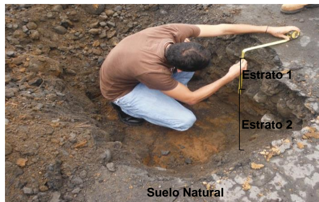
Fotografía 3.2 Medición de espesor de cada estrato de la vía Troncal Amazónica -Mutinsa.
