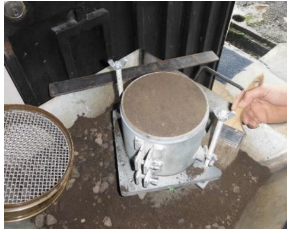
Fotografía 3.8 Alisado y enrasado del suelo.
