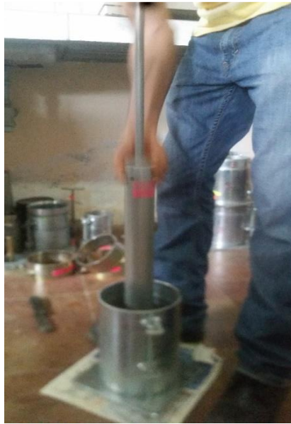
Fotografía 3.11 Compactación de la muestra.
