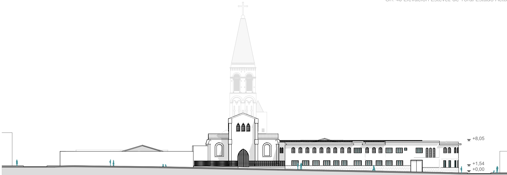
Grf. 40 Elevación Estévez de Toral Estado Actual
