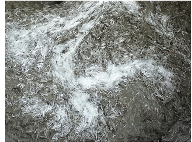
Imagen 20 Mezclado del micro - hormigón y la fibra de vidrio Álcali resistente
