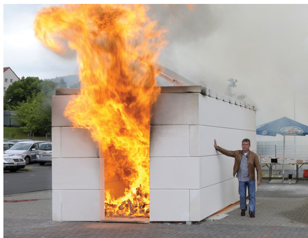
Imagen 24 Ensayos de resistencia al fuego de elementos de hormigón
