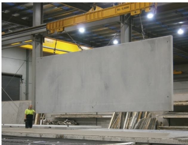
Imagen 26 Paneles prefabricados de hormigón
