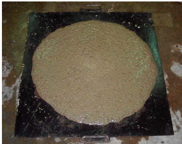
Fig. 2.3 – Hormigón no segregado
