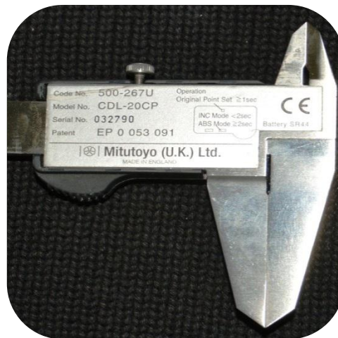
Fig. 10 fotografía de calibrador Mitutoyo con sus especificaciones
