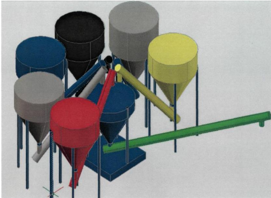
Figura 46 Planta para Pegantes; Dosificadora de Aditivos.
