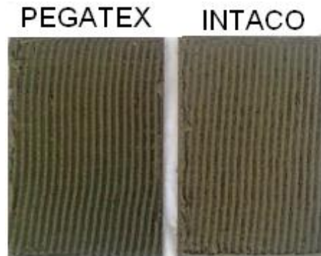
Figura 16 Formación estrías Pegantes STD. Cerámica 25 x 33
