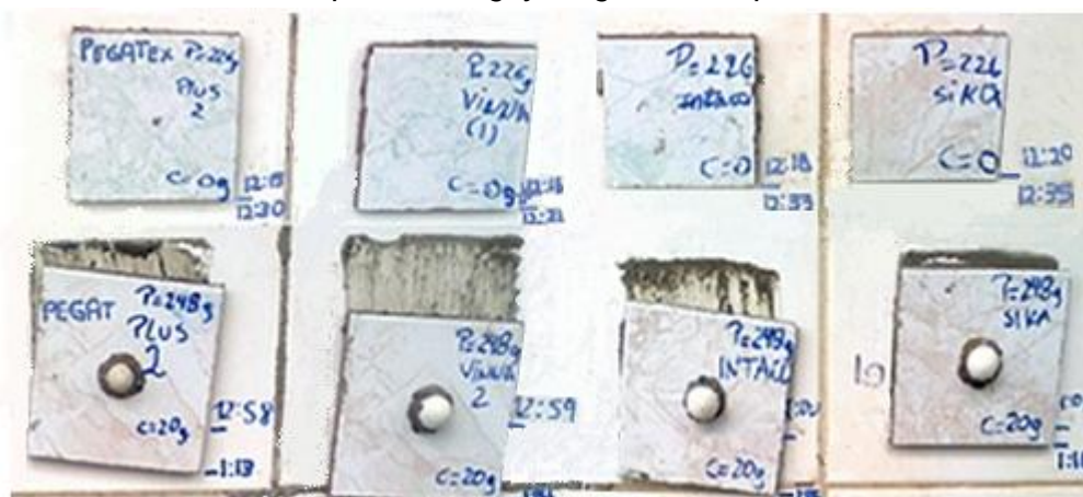
Figura 12 Deslizamiento-Adhesión Pegantes Cerámicos Plus Aplicando 0 g. y 20 g. de sobrepeso
