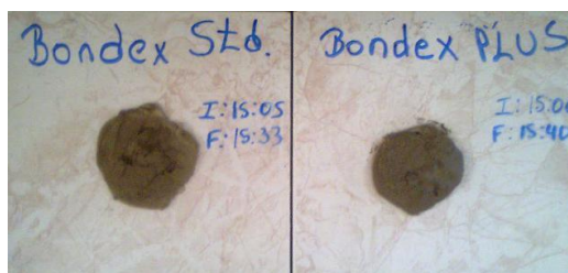
Figura 6 Tiempo Abierto; Pegantes Cerámicos Bondex-Intaco
