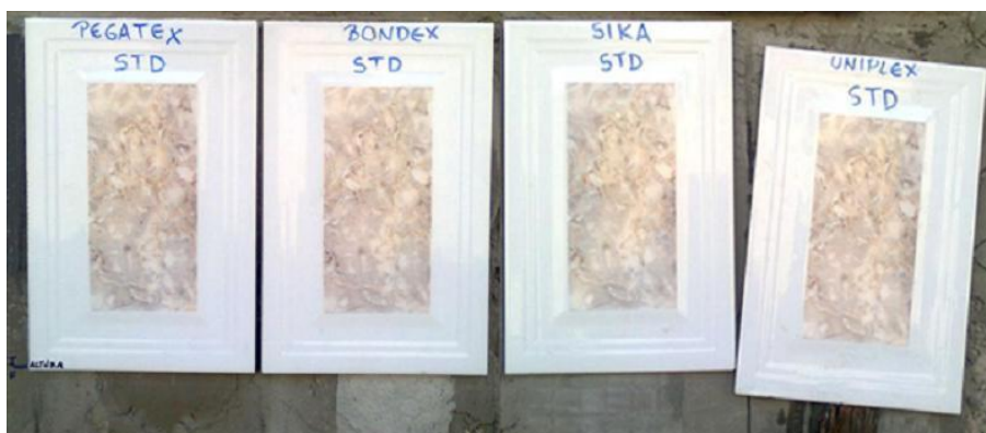
Figura 13 Deslizamiento-Adhesión Pegantes Cerámicos Standard Aplicando 0 g. de sobrepeso
