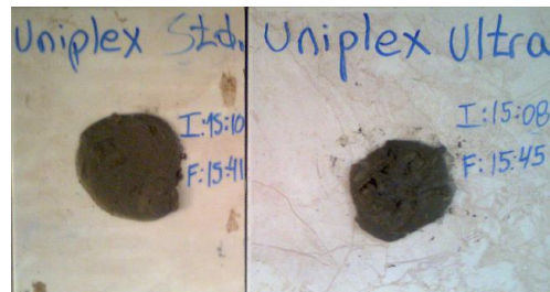
Figura 8 Tiempo Abierto; Pegantes Cerámicos Uniplex - I.Q.A.
