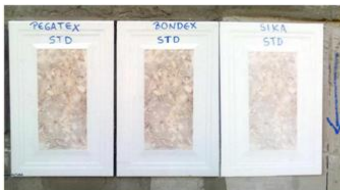
Figura 14 Deslizamiento-Adhesión Pegantes Cerámicos Standard Aplicando 0 g. de sobrepeso
