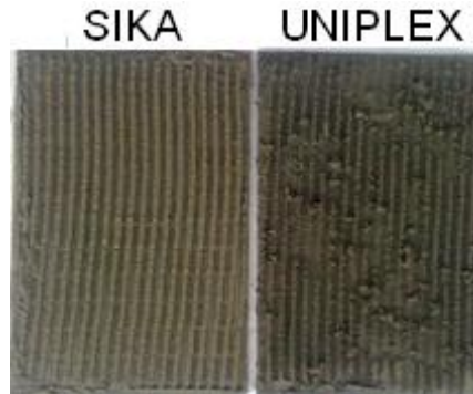
Figura 17 Formación estrías Pegantes STD. Cerámica 25 x 33
