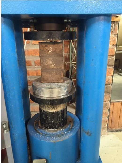
Fotografía N° 3.10 Ensayo a la compresión de ladrillos
