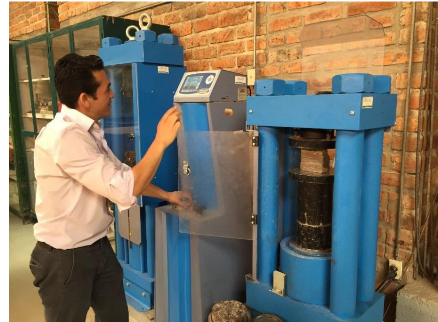
Fotografía N° 3.9 Ensayo a la compresión de ladrillos
