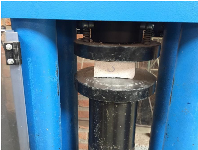
Fotografía N° 3.8 Ensayo a la compresión de ladrillos
