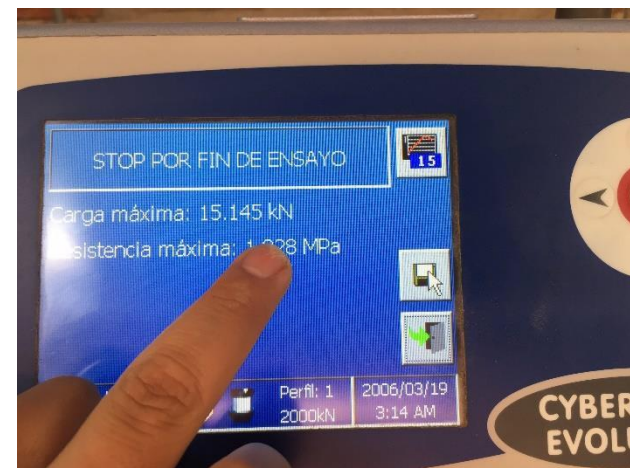
Fotografía N° 3.12 Ensayo a la compresión de ladrillos
