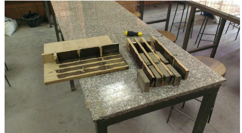
Desencofrado de probetas
