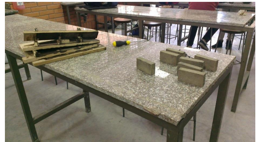
Fotografía N° 3.7 Desencofrado de probetas
