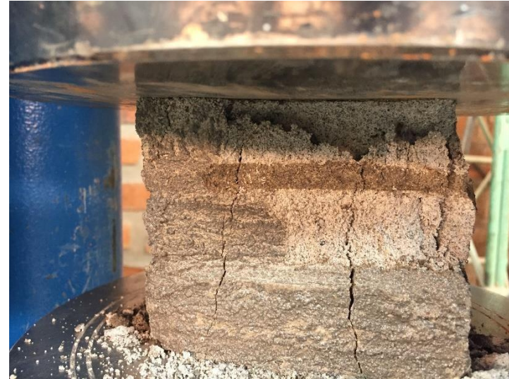
Fotografía N° 3.11 Ensayo a la compresión de ladrillos
