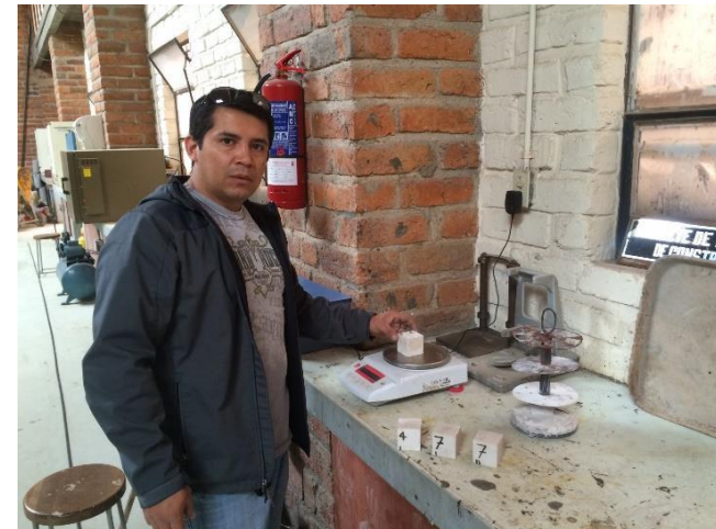
Fotografía N° 3.2 Elaboración de probetas
