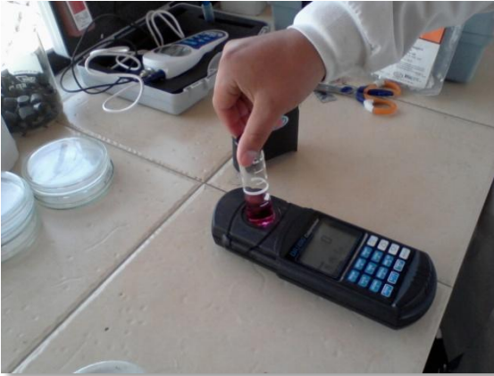
Ilustración 42: Colocación de celda para lectura.
