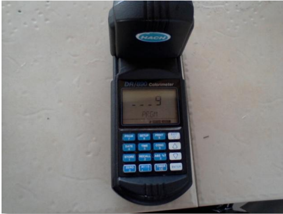
Ilustración 36: Programación del equipo HACH para lectura de Cloro Residual.
