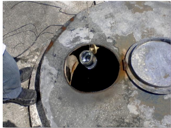
Ilustración 27: Toma de muestra en frasco limpio para determinación de Cloro Residual y pH.
