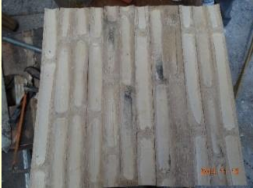
Figura: 54.- Imagen: Encolado de 12 tablillas.
