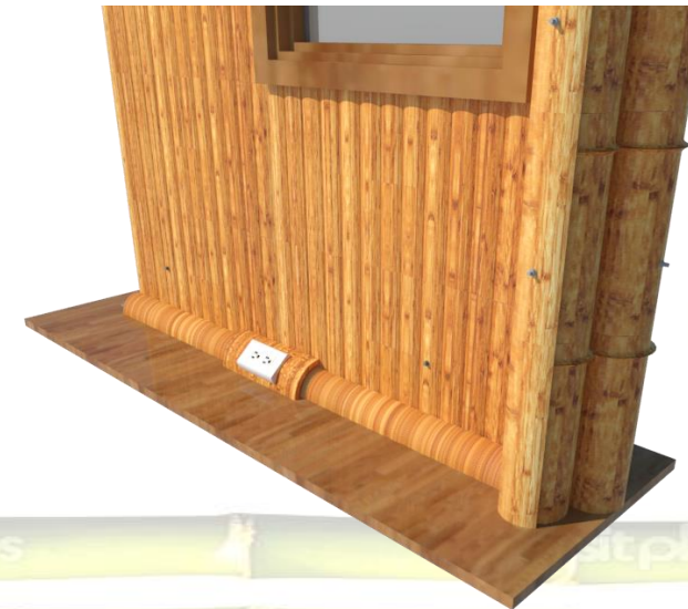
DETALLE DE INSTALACIONES ELÉCTRICAS MAS PANEL II
