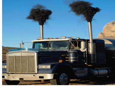
Figura 3: Emisión de grandes cantidades de hollín por las chimeneas de un camión a diesel (23)
