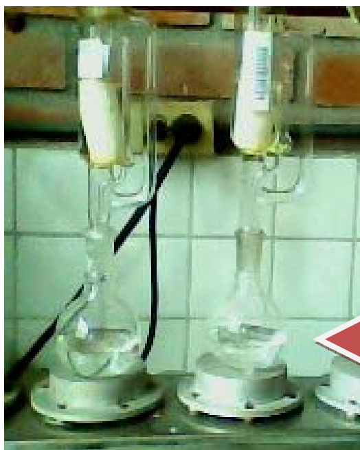
FIGURA N° 5 EXTRACCION DEL ACEITE DE LINAZA MEDIANTE SOXLETH
