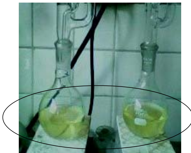
FIGURA N°. 6 OBTENCION DEL ACEITE DE LINAZA MEDIANTE SOXLETH
