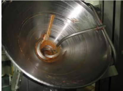
Tolva Embutidora antes de la limpieza
