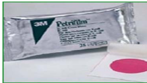
Ilustración 5. Placas petrifilm para el recuento de coliformes totales y coliformes fecales ( E. coli ). 41
