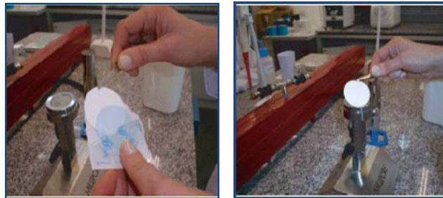
Ilustración 9. Técnica de filtración por membrana. 61
