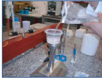
Ilustración 10. Filtración de la muestra. 62
