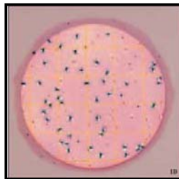
Figura 23. Placa Petrifilm MR EC con crecimiento de E. coli y coliformes totales.
