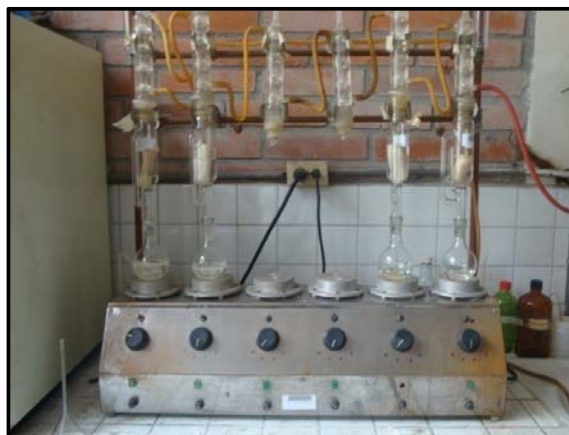
Figura 30. Equipo Soxhlet empleado para determinar el contenido de grasa.
