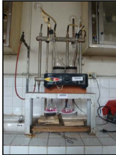
Figura 29. Equipo Kjeldahl empleado para determinar el contenido de proteína.
