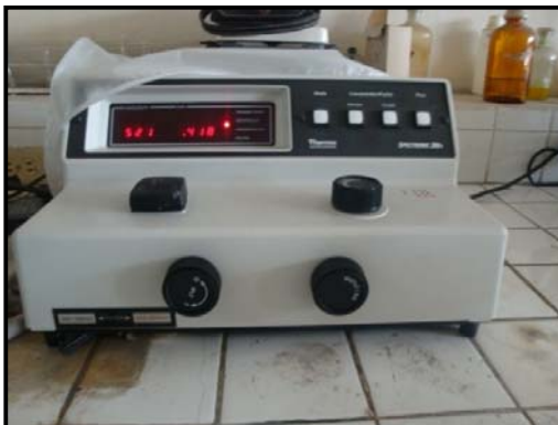
Figura 33. Espectrofotómetro empleado para la determinación de hierro y fósforo.
