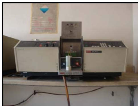
Figura 32. Espectrofotómetro de absorción atómica para la determinación de calcio.
