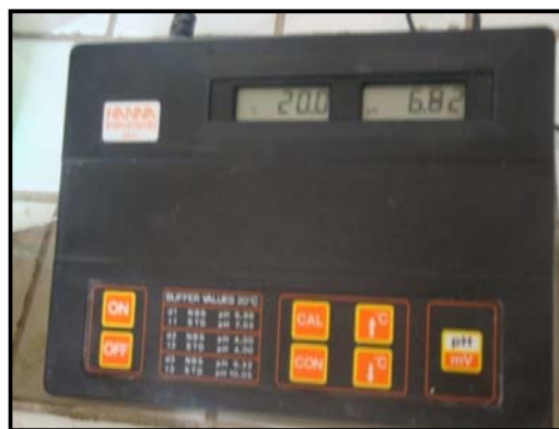
Figura 28. Potenciómetro empleado para la determinación de pH.
