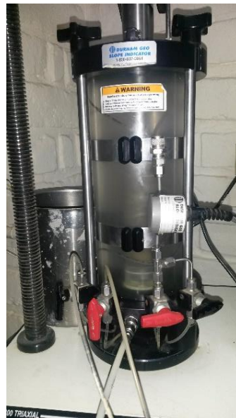
Figura 8. Permeabilidad en cámara triaxial. Fuente: Elaboración propia.
