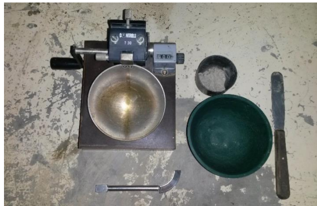
Figura 6. Copa de Casagrande e implementos para el ensayo de límite líquido. Fuente: Elaboración propia.
