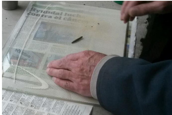
Figura 7. Prueba de límite plástico. Fuente: Elaboración propia.
