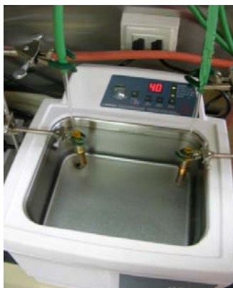
Figura 2.8. Eliminación del solvente con nitrógeno en baño ultrasónico
