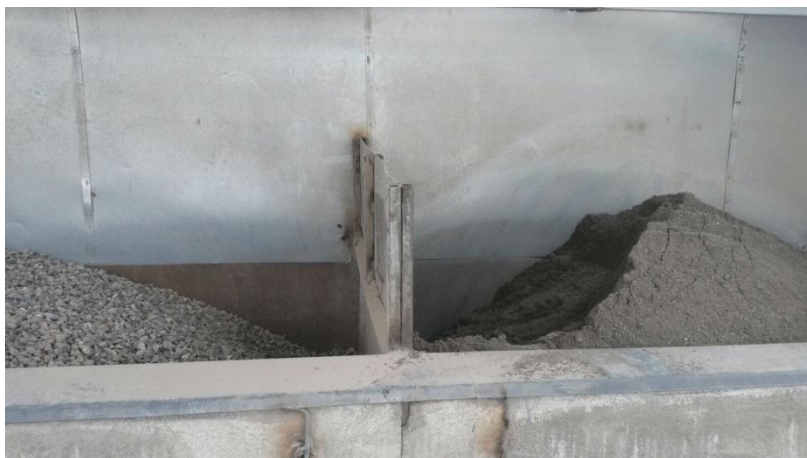
Foto 36 Tolvas con Agregados para la dosificación en la preparación de hormigón Fábrica C-RFV construcciones
