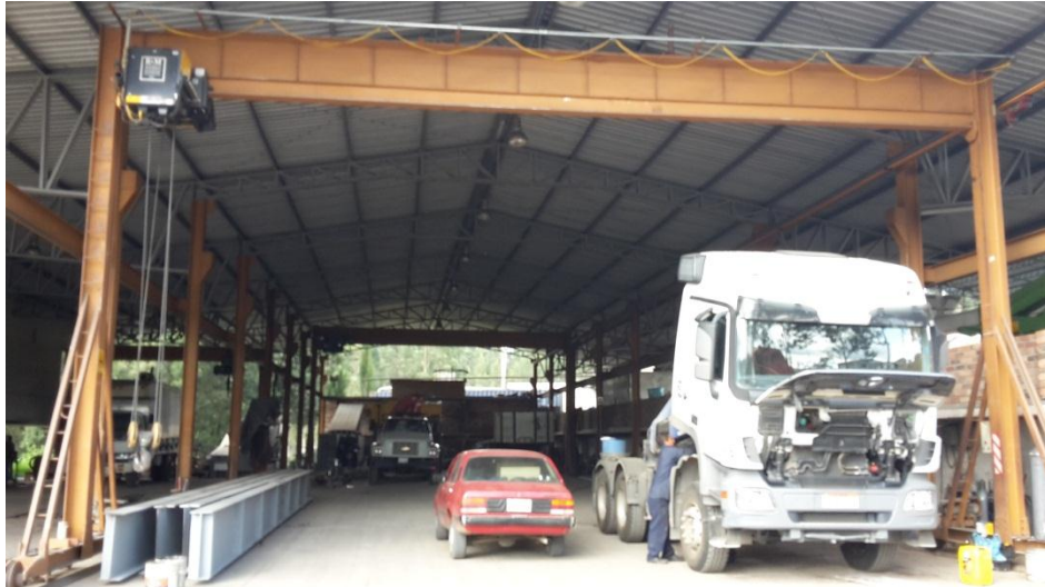
Foto 64 Pórtico con tecla de 5 toneladas para manipulación de dovelas
