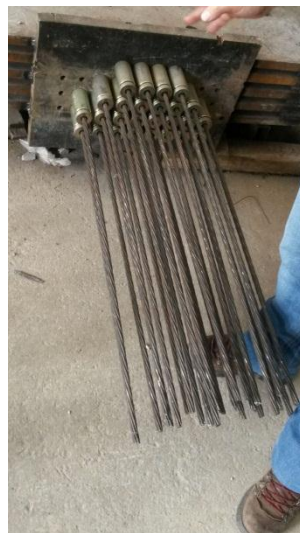
Foto 39 Disposición del Acero de Preesfuerzo En una viga I Fábrica C-RFV construcciones
