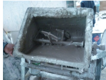
Foto N° 12. Mezclador de carga.
