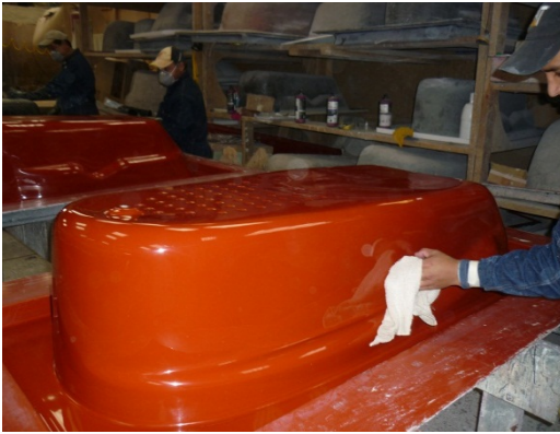
Foto N° 9. Limpieza de moldes
