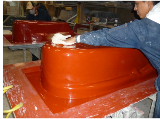
Foto N° 10. Limpieza de moldes
