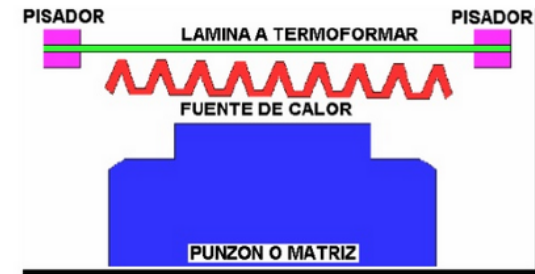
Imagen 1.16 Lámina y herramientas de un proceso de termoformado. Tomado de: (Garrido, 2004)
