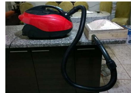
Imagen 3.24 Caja al vacío conectada a la aspiradora. Fotografía de mi autoría.
