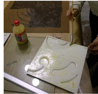
Imagen 4.47 Colocación de pegante en el panel
