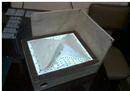
Imagen 3.21 Caja al vacío elaborada en madera. Fotografía de mi autoría.
