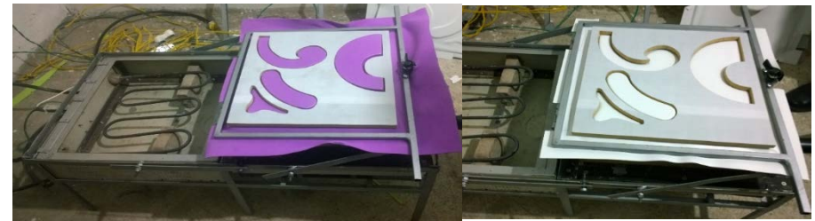
Imagen 3.32 Toma del proceso de termoformado del polímero
