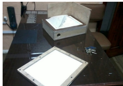
Imagen 3.22 Lámina de PVC sujeta al marco de madera. Fotografía de mi
