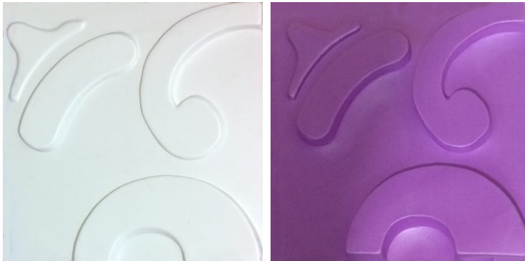
Imagen 3.34 Resultado de paneles termoformados
