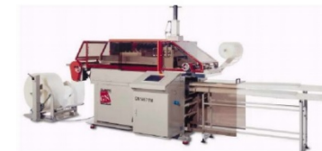
Imagen 1.21 Máquinas termoformadoras alimentadas por rodillo tomada de http://repositorio.uis.edu.co
