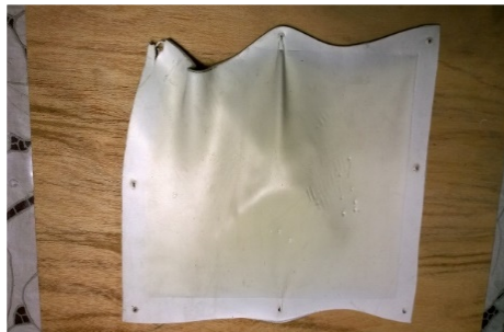
Imagen 3.27 Resultado de termoformado con PVC de 3mm. Fotografía de mi autoría
