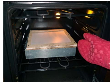
Imagen 3.23 Precalentamiento de lámina de PVC. Fotografía de mi autoría.
