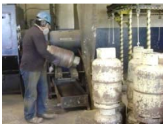
Figura 1.22. Descarga de los cilindros de la Máquina Granalladora.
