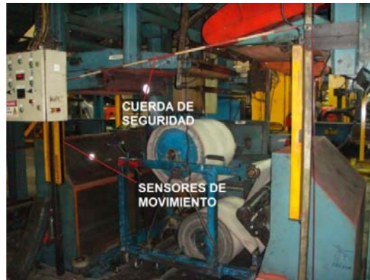
Foto 3.9. Casettera de la Extrusora Roller Head. ERCO Fuente: Quezada-Román
