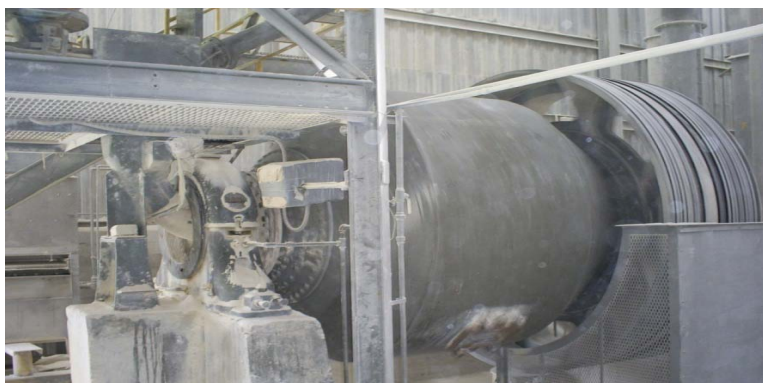
Foto N°8 Molino de Bolas Hardinge, Planta de Molienda de Italpisos Fuente: Los Autores
