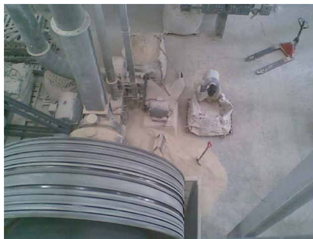
FOTO 12: Atascamiento en las tuberías a la salida del molino
