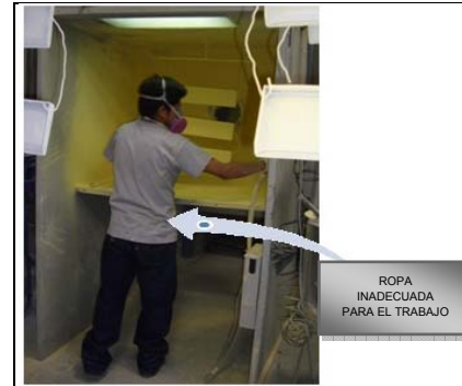
FIG N° 13: Falta de la ropa de protección
