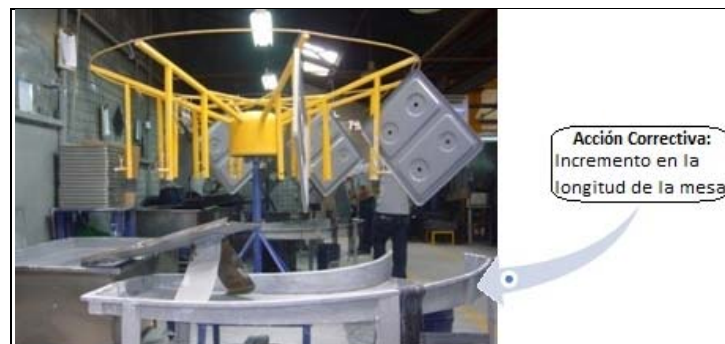
FIG N° 11: Acción correctiva en el área de Loza
