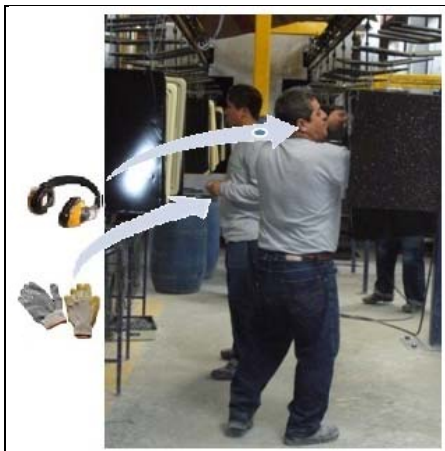
FIG N° 14: Falta del EPP
