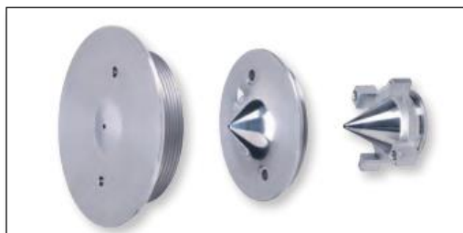
FIGURA 7. CONOS DEL EQUIPO ICP-MS NEXION 350 INCLUIDO EL TERCER CONO SKIMMER HIPER ÚNICO
