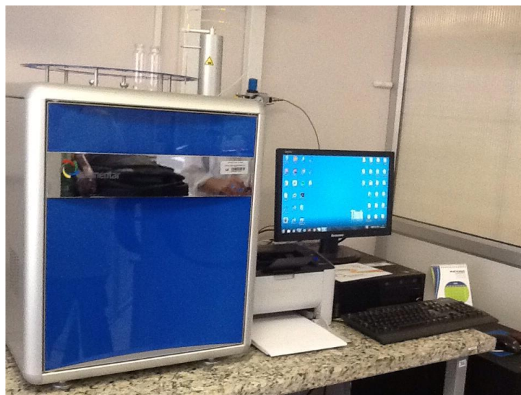
Figura 22. Equipo TOC para análisis de Carbono Orgánico Total
