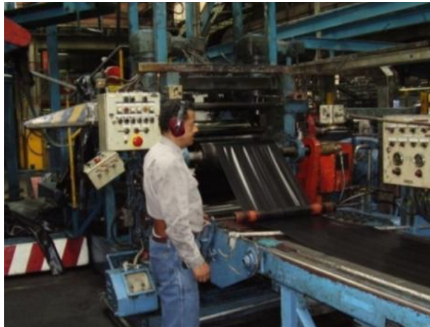
Figura 12. Roller Head, obtención del innerliner
