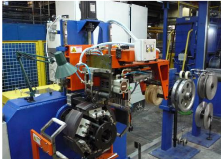
Figura 10. Hexabead, construcción de núcleos
