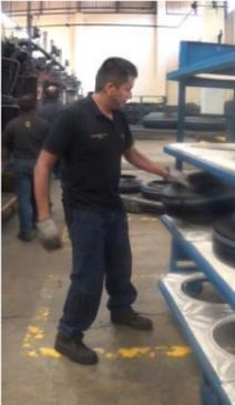
Paso 1: Tomar llanta verde lubricada del carro.
