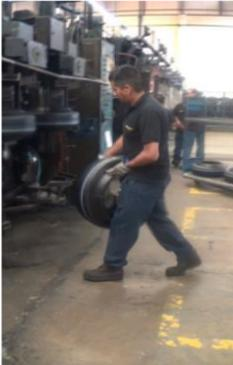
Paso 2: Transportar llanta verde a la prensa.
