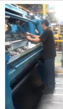
Paso 3: Cambio y ajuste de cuchillas. Tiempo 5 seg.
