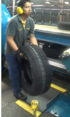
Paso 2: Colocar llanta en rebarbeadora.
