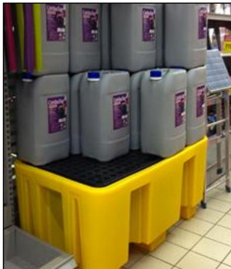
*Fotografía: Plataforma para Bidones y Baldes.
