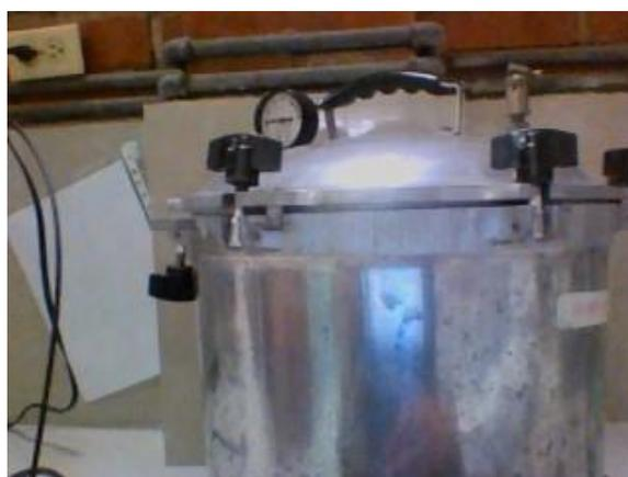
**Figura 4.4.** Autoclave para la hidrólisis
