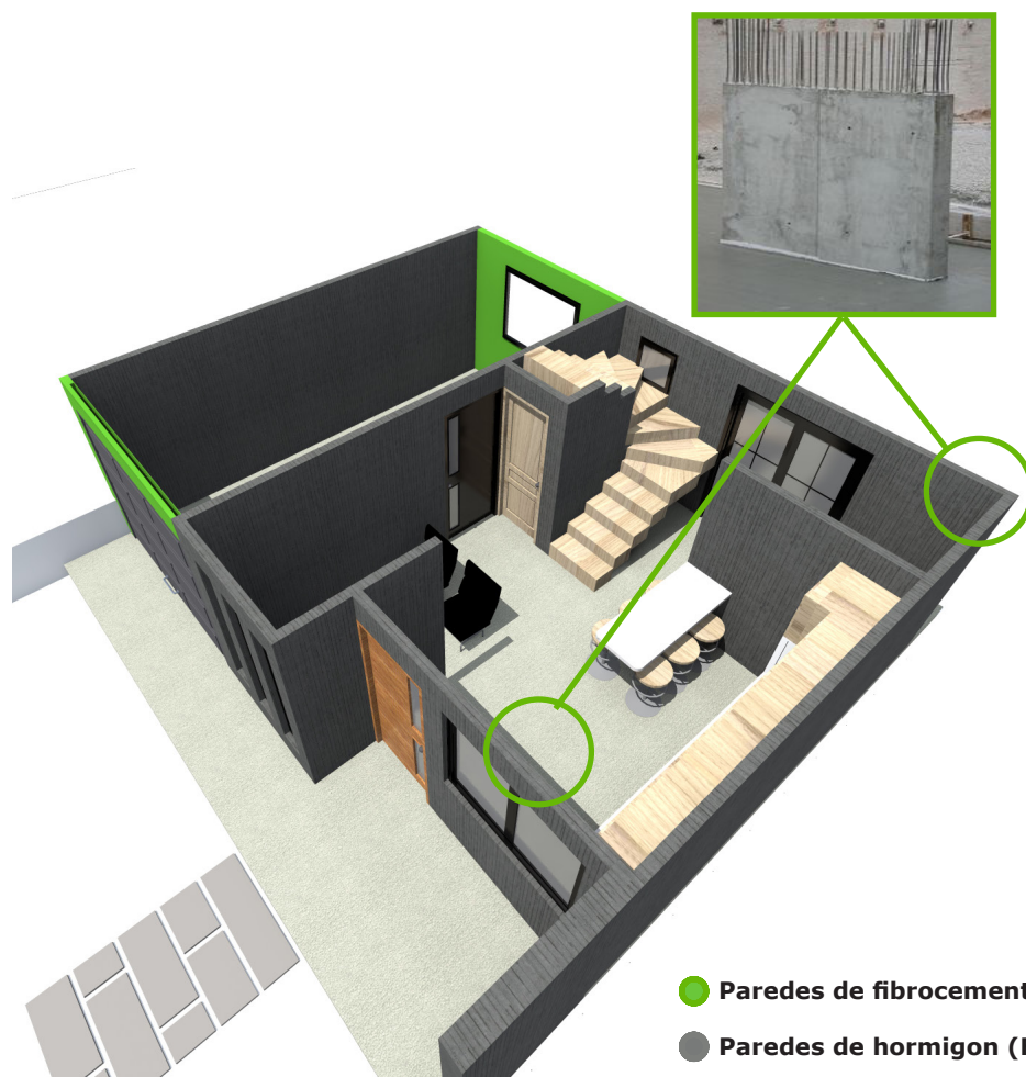
IMAGEN 4.177. Planta baja - tabiques. ELABORACIÓN: Grupo de tesis.
