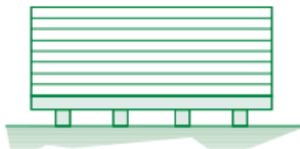
Figura 37: Almacenamiento horizontal de tableros
