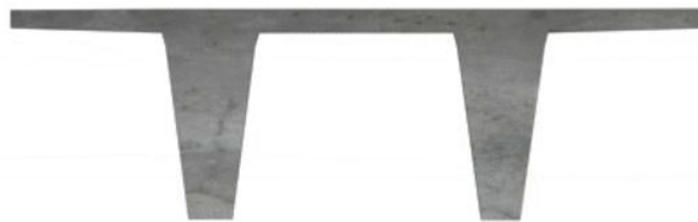
Ilustración 7: Sección transversal losa TT de sección constante.
