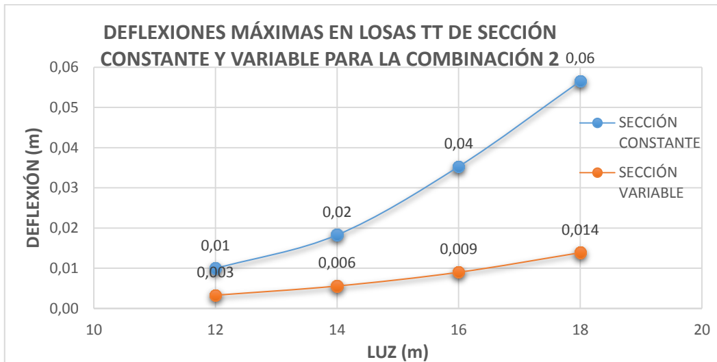
Ilustración 74: Deflexiones máximas en losas TT de sección constante y variable para la combinación 2
