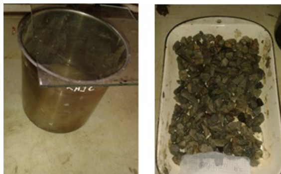
Figura 3.12: Picnómetro con agua y la placa de vidrio y secado del material para lograr la condición SSS.
