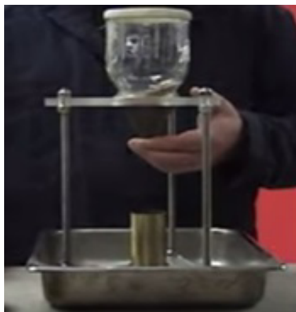
Figura 3.18: Colocación del material mediante el embudo.
