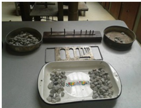
Figura 3.10: Calibradores de espesores y longitudes, separación de partículas elongadas, aplanadas y elongadas-aplanadas.
