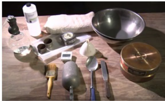
Figura 3.15: Equipo y materiales utilizados ensayo: Equivalente de Arena.
