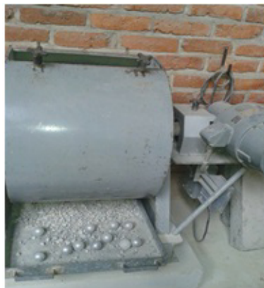
Figura 3.9: Máquina Los Ángeles, con las esferas y el material después del ensayo
