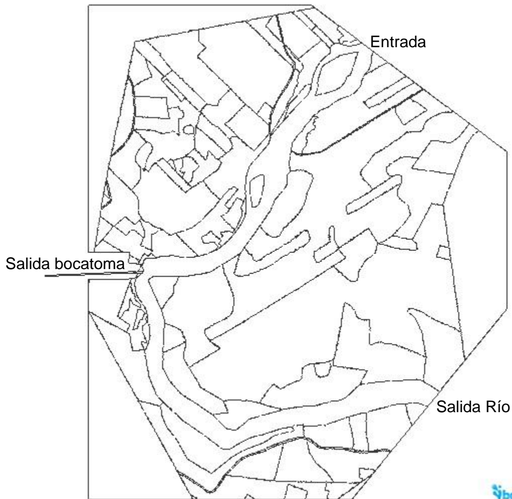
Figura 2.13 Condiciones de contorno del modelo del río Calabí (incorporado la bocatoma).
