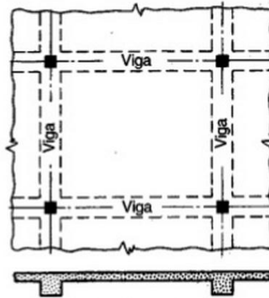
Figura 2.2. Esquema de losa que trabaja en dos direcciones. [12]
