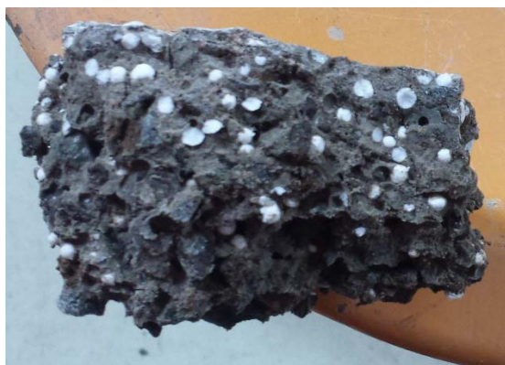
Figura 20. Distribución de las perlas de EPS en el hormigón endurecido
