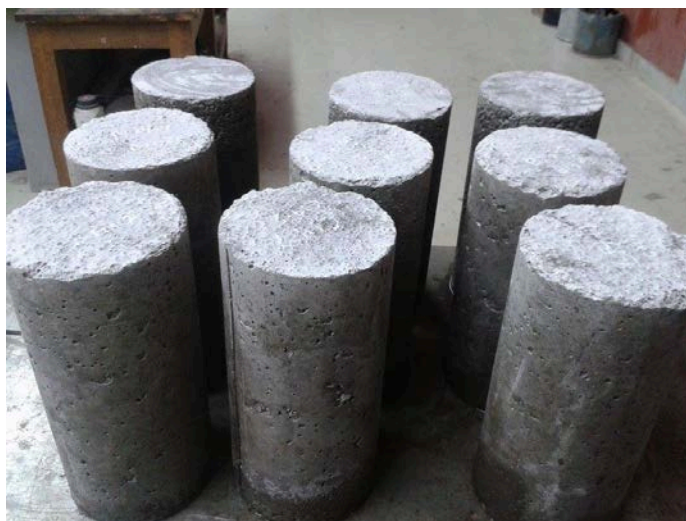
Figura 12. Probetas a ser pesadas y medidas antes del ensayo a compresión
