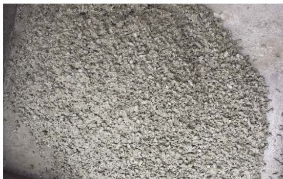
Figura 19. Distribución de las perlas de EPS en el hormigón fresco
