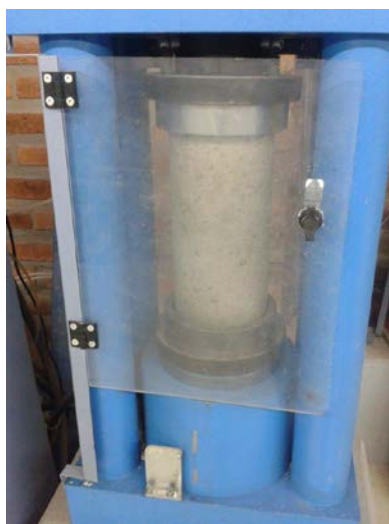
Figura 13. Ensayo a compresión
