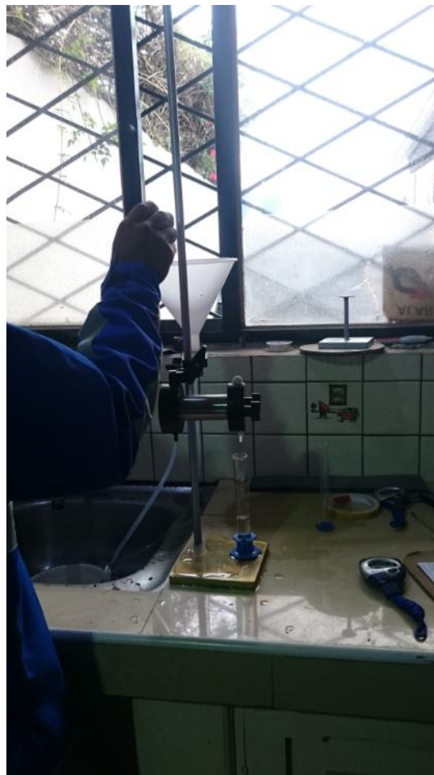
Dispositivo de Pinhole durante el ensayo.
