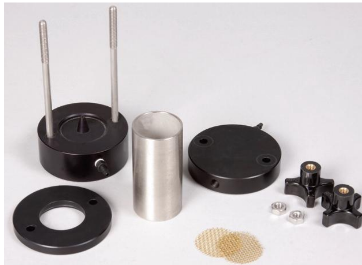
Figura 2.5 Dispositivo para el ensayo de “Pinhole”. HUMBOLDT.
