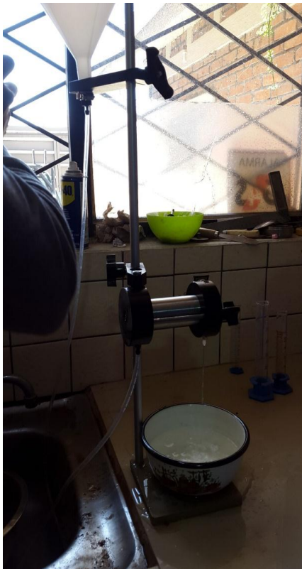
Dispositivo de Pinhole durante el ensayo.
