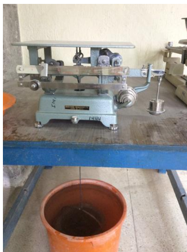
Figura 4.8 Ensayo de densidad de volumen en estado sss y capacidad de absorción del agregado fino. Fuente: Ing. Marlon Espinoza.
