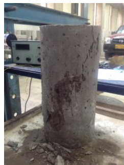
Figura 5.4 Ensayo de Resistencia a la Compresión de la muestra patrón. Fuente: Ing. Marlon Espinoza.
