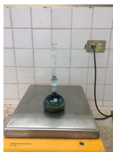
Figura 4.13 Densidad Real del Cemento. Fuente: Ing. Marlon Espinoza.
