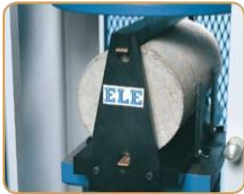
Figura 2.10 EL Plato 37-5420 Ensamble divisor del cilindro. http://schiller.com.ec/concreto/
