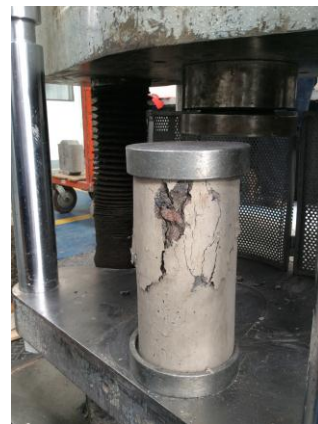
Figura 6.1 Ensayo de compresión de los especímenes de prueba. Fuente: Ing. Marlon Espinoza.
