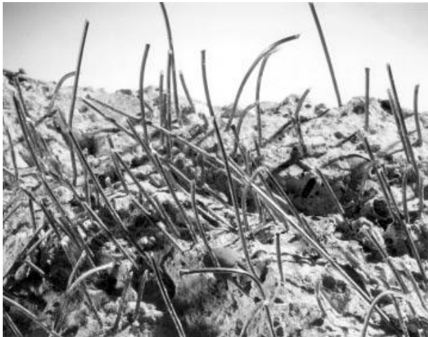
Figura 3.1 Superficie de fractura de Concretos Reforzados con Fibras de Acero. (544.1R, 2002, p. 8)
