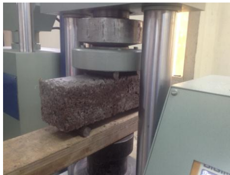
Figura 5.5 Ensayo de Resistencia a la Tracción por flexión de la muestra patrón. Fuente: Ing. Marlon Espinoza.
