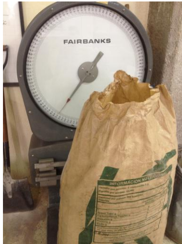
Figuras 3.4 Proceso de muestreo y pesado de las fibras de bagazo de caña. Fuente: Laboratorio EPN Ing. Marlon Espinoza C.
