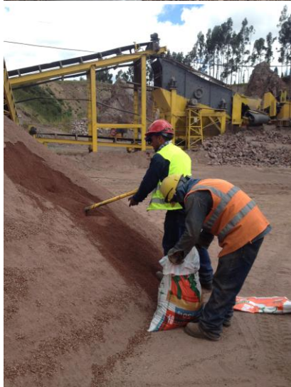
Figura 4.3 Muestreo de los agregados cantera CONSTRUARENAS CIA. LTDA. Fuente: Ing. Marlon Espinoza.
