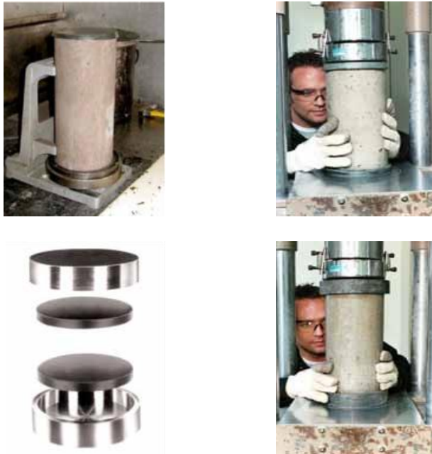
Figura 2.5 Capeo con Azufre y Almohadillas no adherentes de neopreno y rotura de cilindros. (INECYC I. E., 2009)
