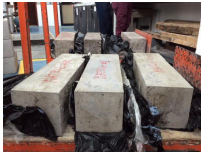
Figura 6.2 Ensayo de tracción por flexión de los especímenes de prueba. Fuente: Ing. Marlon Espinoza.
