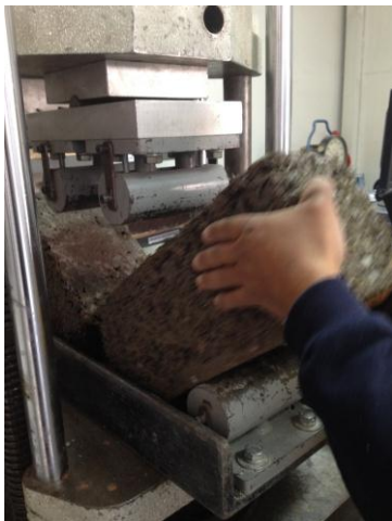
Figura 6.3 Ensayo de tracción por flexión de los especímenes de prueba. Fuente: Ing. Marlon Espinoza.
