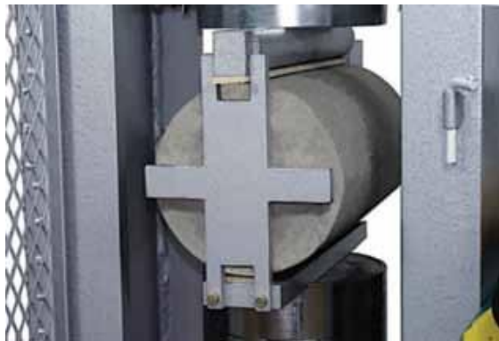
Figura 2.12 Aplicación de carga para el ensayo de tracción indirecta de especímenes cilíndricos. (INECYC I. E., 2009)
