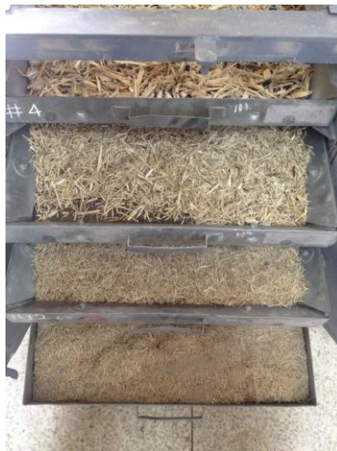
Figuras 3.5 Proceso de tamizado de las fibras de bagazo de caña. Fuente: Laboratorio EPN Ing. Marlon Espinoza C.
