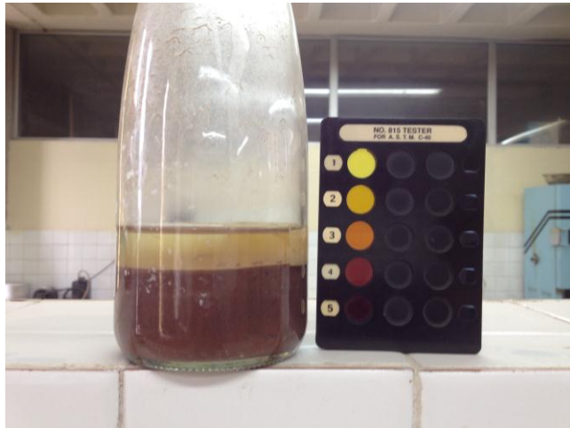
Figura 4.12 Ensayo de Colorimetría. Fuente: Ing. Marlon Espinoza.
