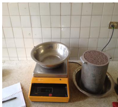
Figura 4.10 Ensayo de densidad aparente del agregado fino. Fuente: Ing. Marlon Espinoza.
