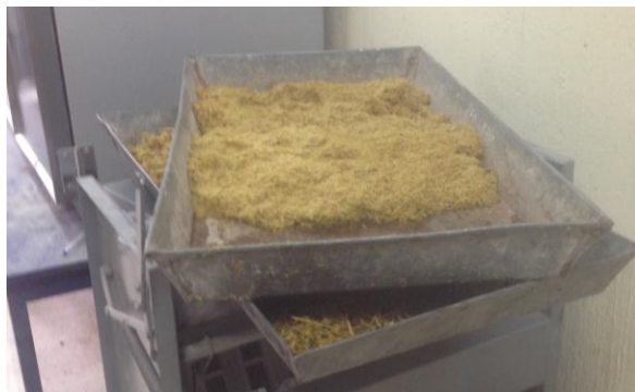
Figuras 3.7 Proceso para el control de degradación de las fibras de bagazo de caña. Fuente: Laboratorio EPN Ing. Marlon Espinoza C.
