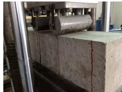
Figura 6.2 Ensayo de tracción por flexión de los especímenes de prueba. Fuente: Ing. Marlon Espinoza.
