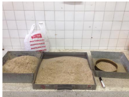
Figuras 3.6 Proceso de tamizado y pesado de las fibras de bagazo de caña. Fuente: Laboratorio EPN Ing. Marlon Espinoza C.
