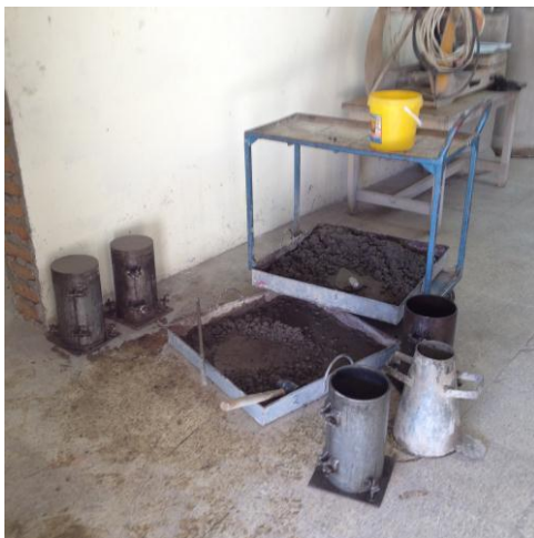
Figura 5.3 Proceso de verificación del revenimiento de la mezcla patrón. Fuente: Ing. Marlon Espinoza.
