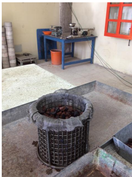
Figura 4.7 Ensayo de densidad de volumen en estado sss y capacidad de absorción del agregado grueso. Fuente: Ing. Marlon Espinoza.
