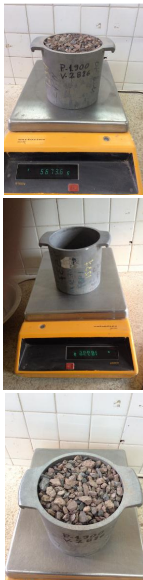
Figura 4.9 Ensayo de densidad aparente del agregado grueso. Fuente: Ing. Marlon Espinoza.
