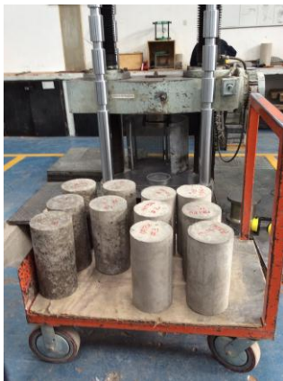
Figura 6.1 Ensayo de compresión de los especímenes de prueba. Fuente: Ing. Marlon Espinoza.
