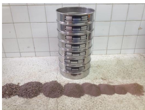
Figura 4.4 Ensayo de granulometría agregado fino. Fuente: Ing. Marlon Espinoza.
