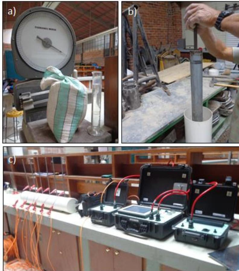
Figura 3.9 Resistividad eléctrica, a) Peso del material, b) Compactación, c) Configuración y medición.
