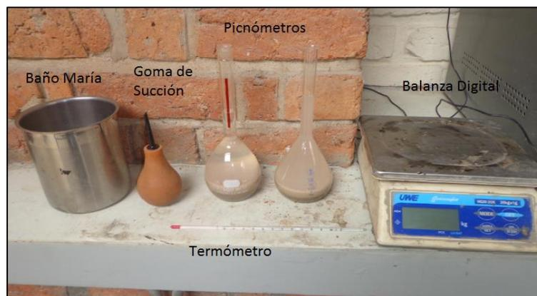
Figura 3.3 Determinación de la masa del frasco volumétrico más lechada.
