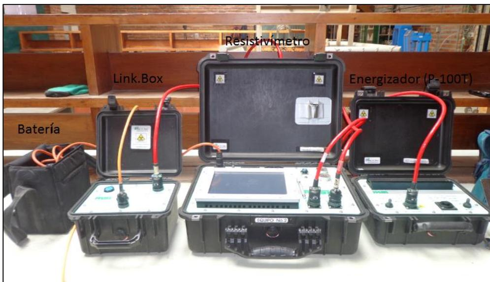
Figura 3.7 Equipos del Resistivímetro PASI modelo 16SG24-N.
