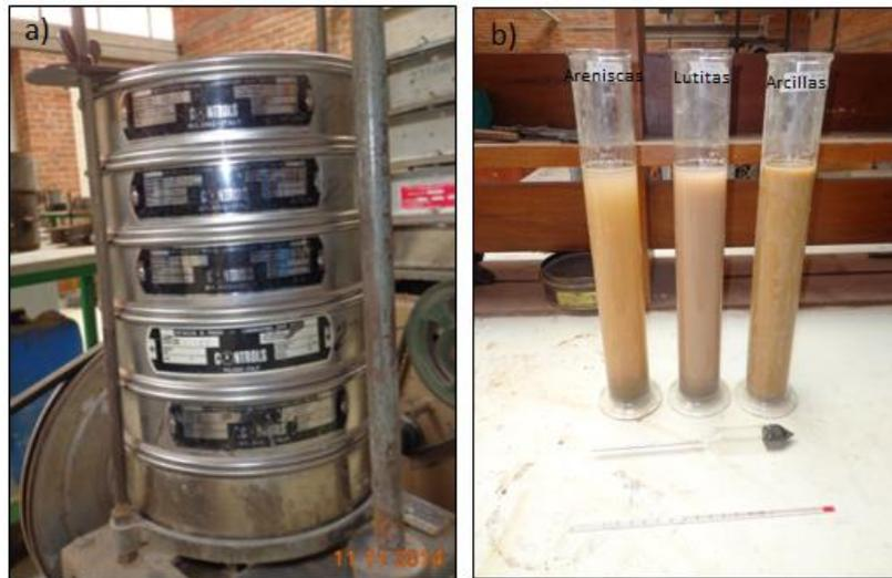
Figura 3.4 Análisis granulométrico por: a) Tamizado e b) Hidrométrico.
