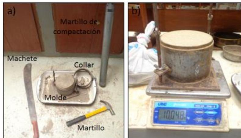
Figura 3.6 Ensayo de compactación Próctor Modificado: a) Herramientas b) Muestra enrazada y pesada.
